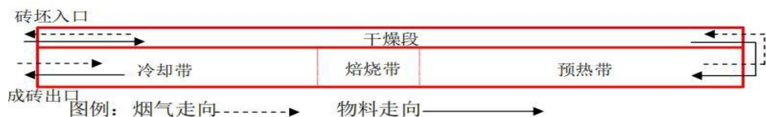
图 2-1 隧道窑中烟气及物料走向图
